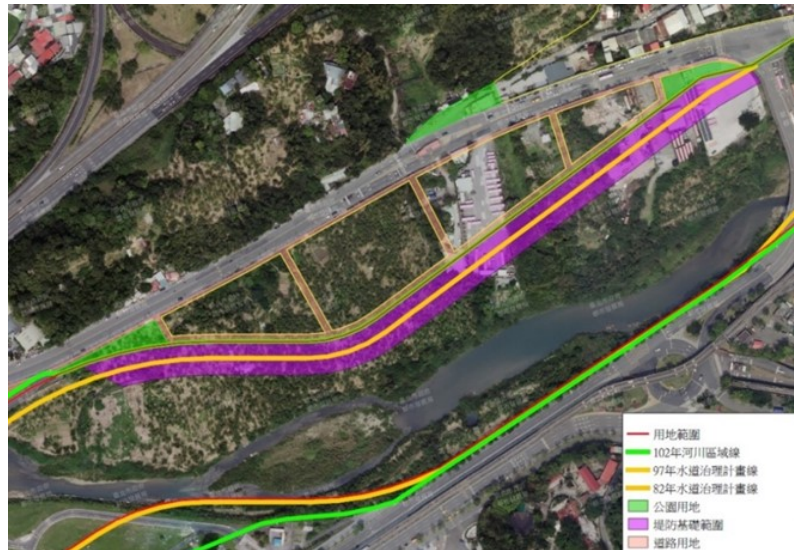
圖 2、河川區域線及堤防基礎範圍示意圖
